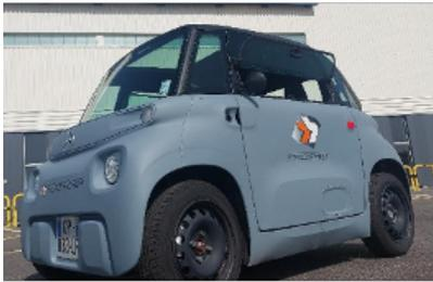
*Je vous présente notre AMI Cargo. Cette petite voiture est 100% électrique et peut se conduire sans permis. Elle possède 75 km d'autonomie et une vitesse maximale de 45 km/h. Sur le site AIRBUS nous ne pouvons pas rouler au-delà de 30 km/h. Elle y trouve ainsi toute sa place. Ce petit cube sur roues ne permet pas de transporter un gros volume de matériel, ni de matériel encombrant mais il a un volume de chargement de 400L.*
